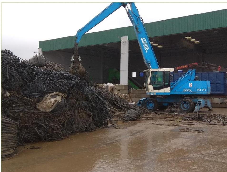
*Figura 2:* Maquinaria manipulando residuos plásticos de origen agrario.
